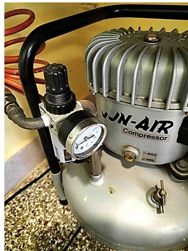
Defekter Lufruckregulierer an Jun-Air Kompressor ersetzt.
