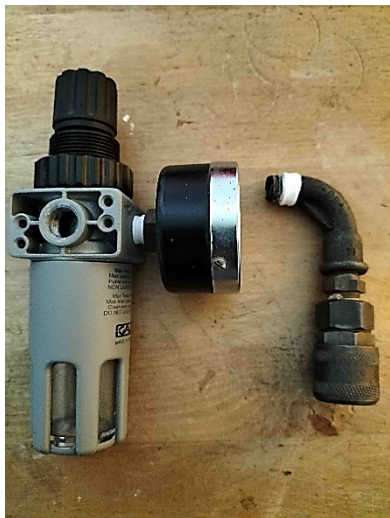
Defekter Lufruckregulierer an Jun-Air Kompressor ersetzt.
